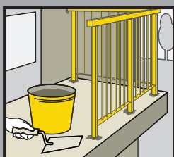
Balkonų turėklų tvirtinimas
