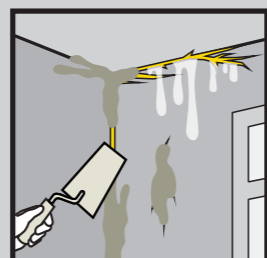
Plaisu labošana un aizsardzība pret ūdens iesūkšanos – iekštelpās
