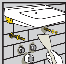
Santehnikas piederumu un mēbeļu uzstādīšana
