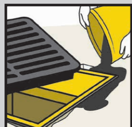
Notekūdeņu aku un drenāžas režģu nostiprināšana
