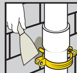
Ūdens notekcauruļu stiprinājumu uzstādīšana
