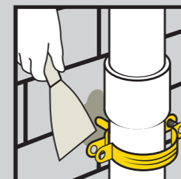
Vandentiekio vamzdynų tvirtinimo elementų montavimas
