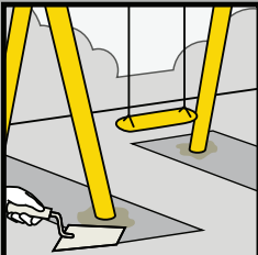
Játszóterek eszközeinek rögzítése
