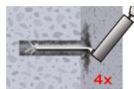
След почистване, отвора трябва да се предпазва от вторично замърсяване до нанасянето на химическия анкер.
