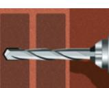
Монтаж в плътна или решетъчна зидария с мрежест дюбел. Отворите се пробиват перпендикулярно на основата. С перфоратор се пробива отвор в основата с нужния диаметър и дълбочина, според вида на избрания анкер. (Таблица В1) В случай на неправилно пробит отвор, същия трябва да се запълни с подходящ разтвор.
