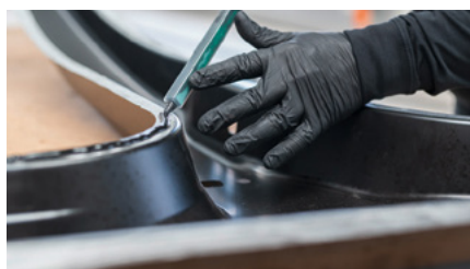
Application facile à la buse automélangeuse
