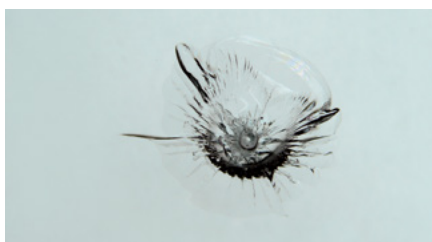
b) fissure ouverte/impact en étoile
