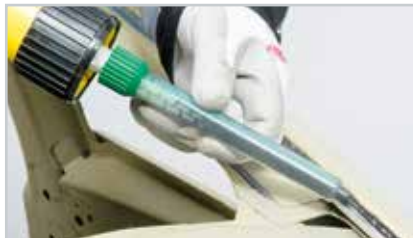
Application facile avec le mélangeur statique.
