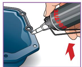
※長期保管でノズル内のシール剤が硬化した場合、ノズルを取り外して硬化したシール剤を取り除いて下さい。
