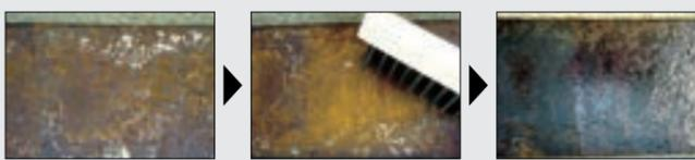
どこにでもある赤錆び。塗布前に表面に浮いている赤錆びをワイヤーブラシなどで落とします。エクステンドを塗布すると赤錆びが黒錆びになります。塗布した後は、表面に塗料を塗ることも可能です。
