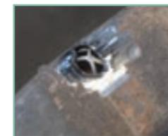
金網が補修部分を補強し、エポキシ補修剤の裏あてとなります。
