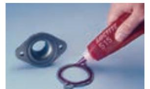
フランジシール用標準品で、硬化後も柔軟性を有しています。ギアケース、ポンプ、コンプレッサのフランジシールに適しています。プライマー使用時の最大隙間は 0.25 mm です。
