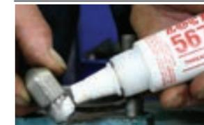
ステンレス配管継ぎ手用のシーリング剤です。締付け時に潤滑性を発揮しかじり付きを防止します。
