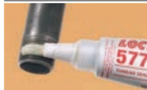
中強度のシーリング剤で繰り返し耐衝撃圧に優れています。油圧機器のねじ継ぎ手、プラグなどのシーリングに適しています。高粘度でチキン性を有しておりフランジ面への使用も可能です。
