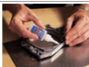
繊維・紙・皮革・レンガ・発泡体も接着します。また、難接着材であるPE、PP、PBT、ポリアセタール、軟質塩ビ、ポリウレタン、シリコンゴム等も強力接着が可能です。
