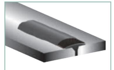
図 11. エポキシ補修剤とテープの上に、更に、エポキシ補修剤を上塗りします
