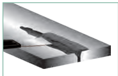
図 9. 補修部にエポキシ補修剤を充填します
