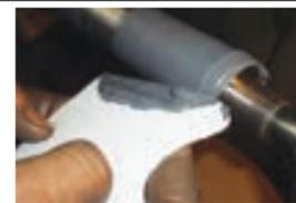
シリコン入りのエポキシ補修剤で、腐食、摩耗、苛酷な環境にさらされる表面の保護や再生に最適です。優れた圧縮強度と耐薬品性を持っています。非腐食。
