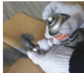
アルミ、グラファイトを含む汎用焼き付き防止剤。金属接合部を焼き付きから守り、ねじ部のかじりや腐食を防止します。高温環境にさらされる潤滑チェーン、留め具、低速ベアリング等に。極度の高温、低温においても蒸発したり固くなりません。870℃までの耐熱性あり。MIL-PRF-907Fに適合。
