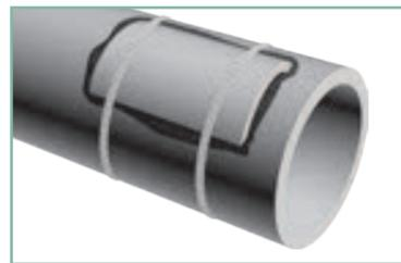
図 4. エポキシ補修剤が硬化するまで修理部をワイヤーで押さえるかクランプで留め、修理部を補強します
