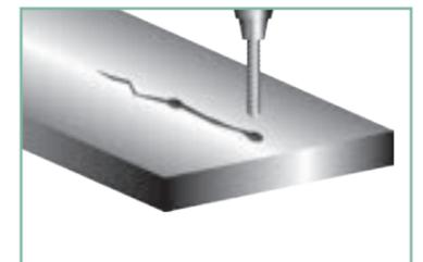
図 8. 割れの一方の端に穴をあけます
