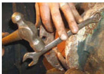
腐食してしまった部品は取り外しが困難に・・・
