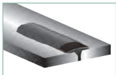
図 11. エポキシ補修剤とテープの上に、更に、エポキシ補修剤を上塗りします
