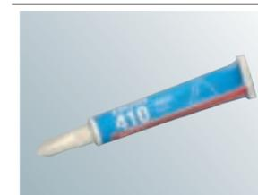
優れた耐衝撃・耐剥離性を持っています。また、70℃×95%×1,000時間の耐湿性テストでも、およそ70%の強度を維持し、100℃×1,000時間の熱エージングでもおよそ80%の強度を維持します。
