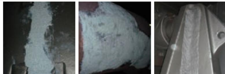
セラミックスの小さなビーズと炭化硅素を配合した耐摩耗コート剤で 121℃以下にて微粒子による摩耗に対して強力に保護します。コテ塗りができます。
