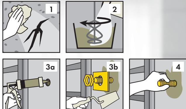
1. Priprema podlage: CX 5 EXPRESS brzovezujući cement može se koristiti na kompaktnim, opterećenim i čistim podlogama bez supstanci koje umanjuju efekat lepljenja, kakve su mast, bitumen ili prašina. Podlogu je potrebno navlažiti velikom količinom vode, bez stvaranja barica.
