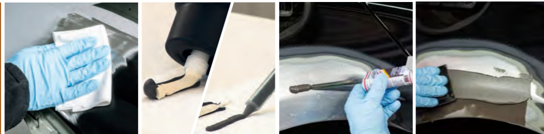
Flächen mit TEROSON VR 10 reinigen und vorbereiten
