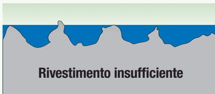
Una corretta rugosità, ma con un insufficiente strato protettivo, lascia il metallo esposto a ruggine e/o contaminazione.
