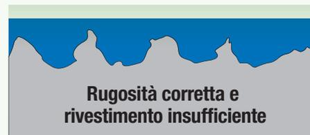
E' fondamentale ottenere la corretta rugosità superficiale e il giusto spessore di prodotto. Per applicare i prodotti Loctite® è richiesta una rugosità minima di 75µm. Solo con questa rugosità e un sufficiente strato di rivestimento si può garantire la massima adesione del protettivo.
