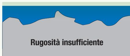
La rugosità superficiale varia a seconda del tipo e della dimensione degli abrasivi che urtano la superficie. Una scarsa rugosità superficiale fornisce un ancoraggio insufficiente che porta a un distacco del protettivo.
