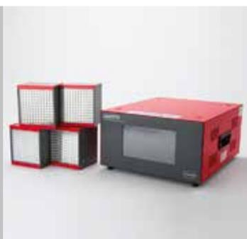
La centralina Quad LOCTITE EQ CL30 fornisce alimentazione e controllo per fino a 4array di LED a luce diffusa LOCTITE. Sono disponibili lunghezze d'onda da 365 nm e 405 nm. La lunghezza d'onda dell'array viene selezionata in base ai requisiti di polimerizzazione dell'adesivo.
