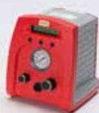
Il sistema di dosaggio multiuso a siringa LOCTITE 98666 è un sistema di erogazione elettro-pneumatico digitale. Il sistema viene consegnato pronto per essere messo in funzione; include aghi dosatori, adattatore per cartucce, supporto per cartucce e interruttore a pedale.
