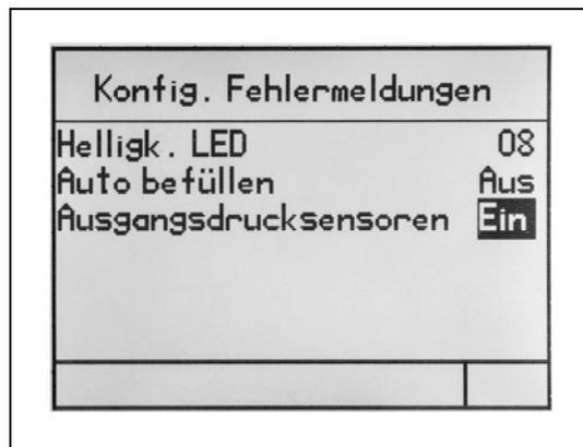
Sind die Drucksensoren ausgeschaltet (deaktiviert), so wird die nebenstehende Statusmeldung angezeigt.
