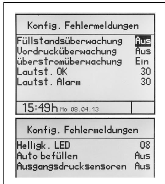
Ist die Funktion Füllstandsüberwachung mit EIN aktiviert (automatisch mit Anschließen eines Reservoirs) und sinkt der Füllstand im Reservoir soweit, dass eine Leermeldung herausgegeben wird, lässt das Steuergerät keinen weiteren Start des Dosierers zu.
