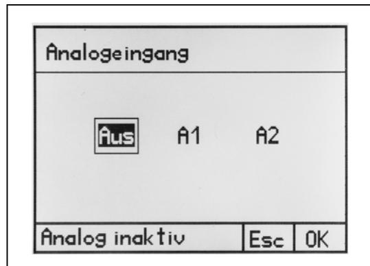
A1: 0-10 V DC, entspricht 0-6 ml / min max. Durchflußrate (A + B, unabhängig vom Mischungsverhältnis).
