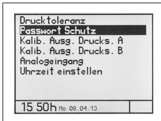
„Ein“ ist automatisch markiert. Das heißt, der Passwort-Schutz ist ausgeschaltet (Schutz inaktiv, siehe Statusanzeige). Durch Drücken der Taste **8** *ENTER* kann er ein- bzw. ausgeschaltet werden.
