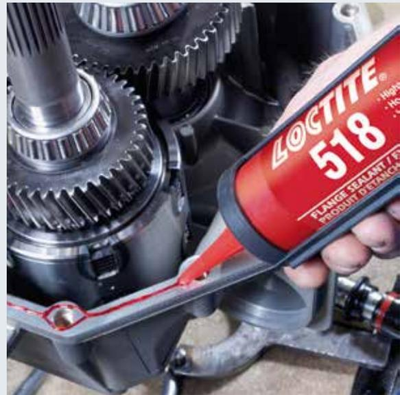
Para garantir que os requisitos de vazamento zero sejam atendidos, é essencial que as juntas sejam projetadas de acordo com parâmetros específicos. A finalidade deste guia é fornecer considerações gerais de projetos que sejam independentes do tipo de junta, bem como diretrizes específicas para juntas líquidas, como juntas formadas no local com cura anaeróbica e elastômeros RTV (vulcanização à temperatura ambiente).
