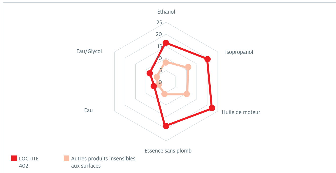
Figure n° 12 Résistance au cisaillement en traction (N/mm 2 ) pour LOCTITE 402 et l'adhésif insensible aux surfaces ordinaires sur l'acier inoxydable après 1 000 heures de vieillissement environnemental au contact de divers solvants et supports.
